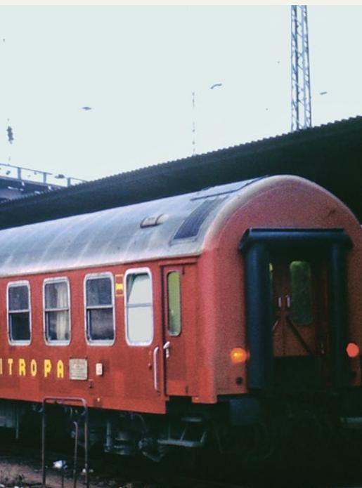
**Abb. 9** Mitropa-Schlafwagen, Bauart WLABme (OSShD, Görnitz, Baujahr ab 1970), am Schluss des IEx 73 »Metropol«, 1990
